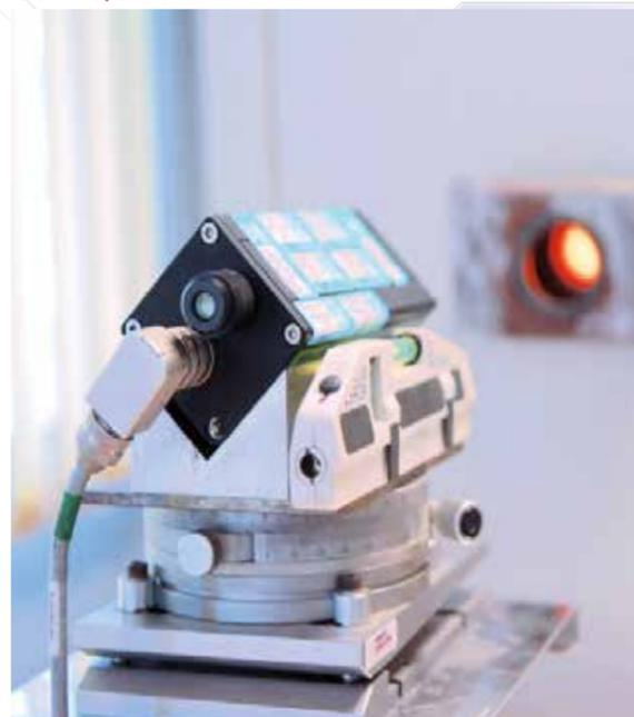
Les pyromètres sont des instruments de mesure de température qui travaillent selon le principe de la technique de mesure par infrarouge. Le service **Thermo Est** exclusif est complet avec des prestations en laboratoire et sur site.
