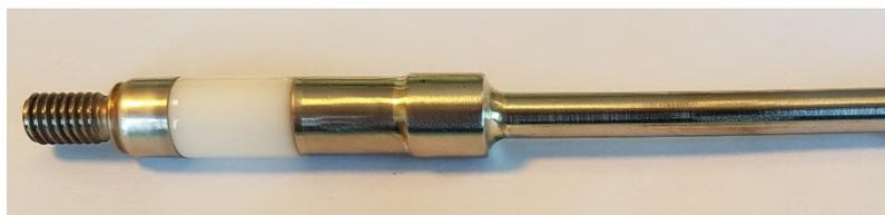
Le raccordement électrique des câbles chauffants via les connecteurs métal/céramique doit être effectué avec des outils adaptés pour ne pas détériorer la céramique qui permet de garantir l'étanchéité du câble chauffant.
