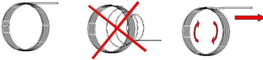
**!! Ne pas plier les câbles à moins de 5 centimètres des jonctions !! Ceci pourrait les endommager, NE JAMAIS PLIER OU FORCER SUR LES SOUDURES DES JONCTIONS**
